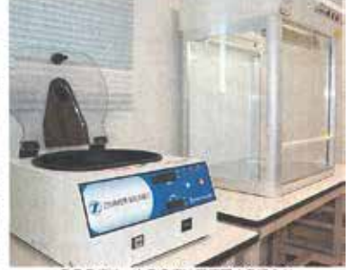
PRP療法、APS療法で使用される遠心分離機（左）と無菌状態で作業するためのクリーンベンチ（大分市の明野中央病院）
